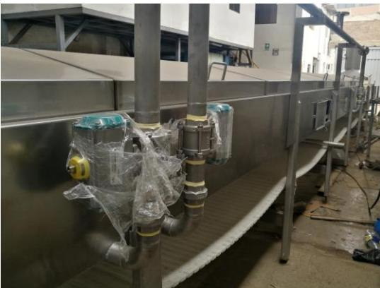
Maquina equipado con PT100 ,controladores de temperatura zonificado enlazado a la válvula de control de vapor
