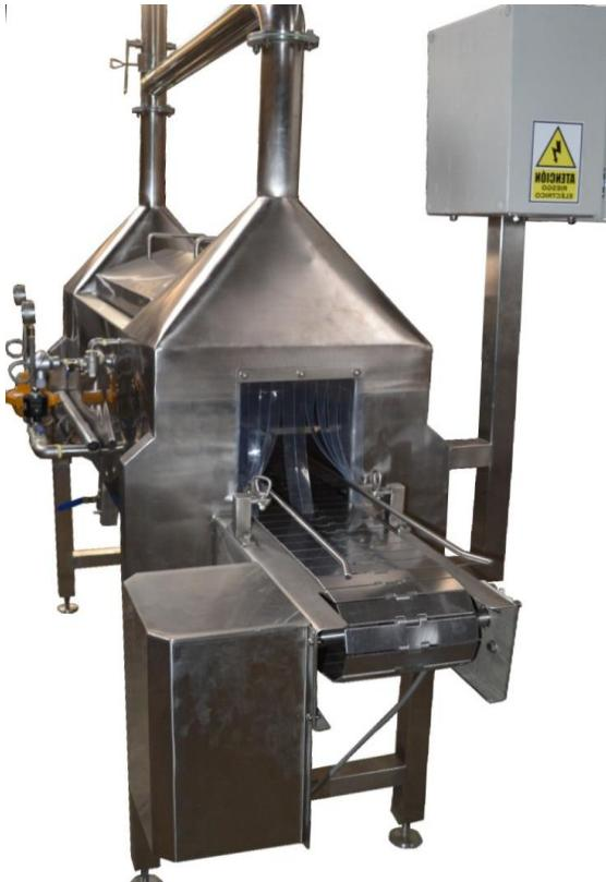
El Exhauster es un túnel con una faja transportadora, donde se realiza la aplicación de vapor saturado al producto para generar el vacío necesario para la etapa posterior de tapado.
