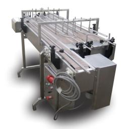
Los **transportadores de tablillas de acetal y/o acero inoxidable**, rectas o curvas, realizan un trabajo de baja fricción de esta forma les permite realizar paradas sin dañar el envase o cajas.
